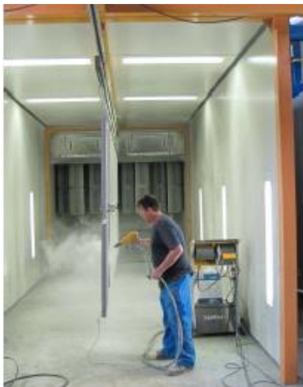
Figure 6 : photographie d'une opération de poudrage (source : REVETTECH)
