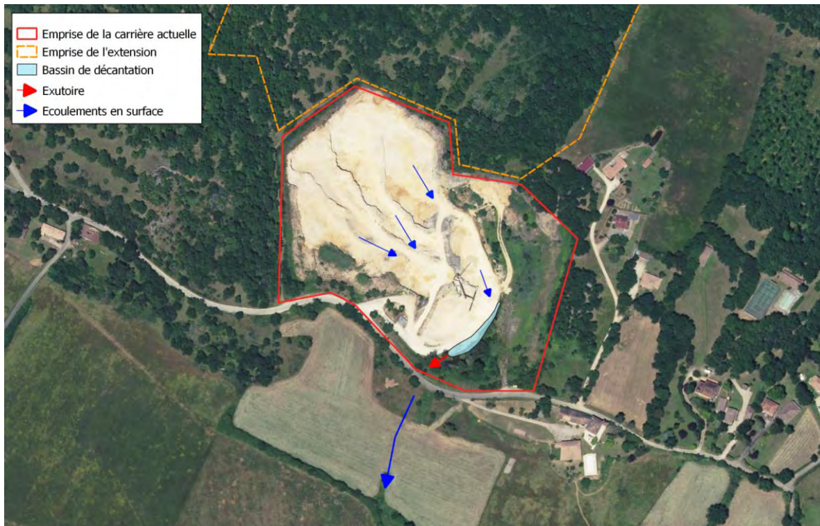
Schéma de gestion des eaux de la carrière actuelle
